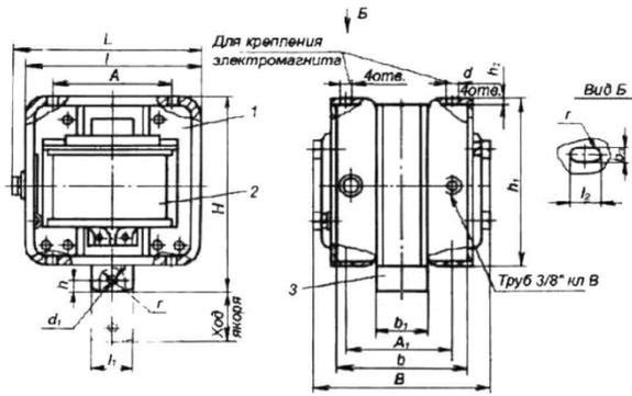
Рисунок 1. Габаритные размеры электромагнита МИС-1100, МИС-2100, МИС-3100, МИС-4100
