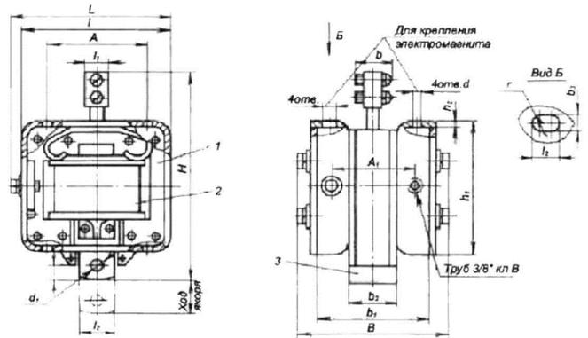
Рисунок 2. Габаритные размеры электромагнита МИС-1200, МИС-2200, МИС-3200
